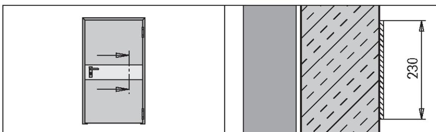
Fascione in lamiera inossidabile satinata **INOX** dello spessore di 10/10 mm da fissare con nastro biadesivo sull'anta in corrispondenza della maniglia. Fornitura su richiesta per porte ad una e due ante (indicare il lato di applicazione).
